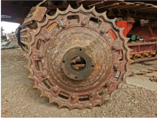
**Fig. 4.** Damage on sprocket.
