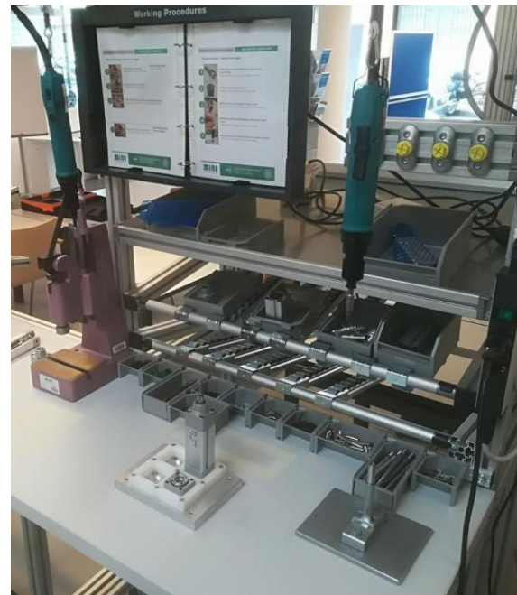
Fig. 1. Manual assembly workstation in the Smart Mini Factory lab.
