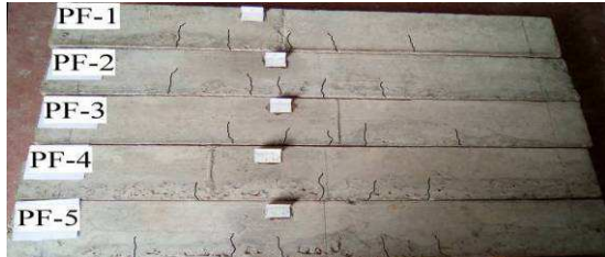
Fig. 2. Pré-fissuration des spécimens d'épreuve.
