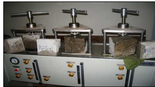
Fig. 3. Appareillage pour la mesure de la perméabilité à l'eau (profondeur de pénétration d'eau)
