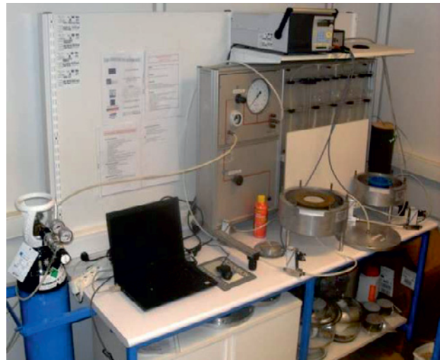
Fig.1. Dispositif expérimental de l'essai de la perméabilité au gaz (CEMBUREAU), (Laboratoire GeM – IUT de St-Nazaire – Nantes)
