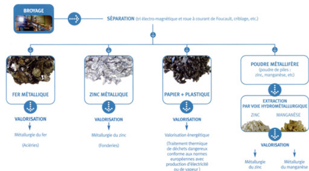
Figure 4. Traitement des piles Zn/MnO 2 mis en place chez EuroDieuze Industrie(57).
