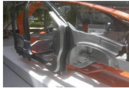
Figure 7. Le pilier A du projet S-in-Motion en inox 301M 1.4310 écroui à 1000 MPa offrant 28 % de potentiel d'allègement.
